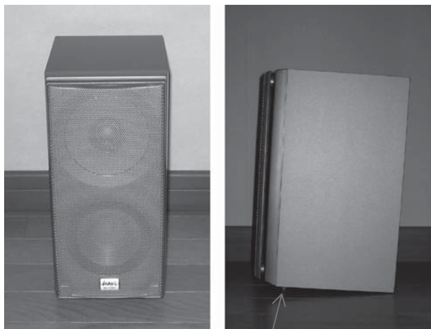
SD-AT10-Sは、傾斜型のスピーカーで、ここを浮かしている。
