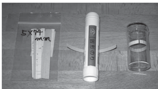
写真 14 材料の加工と固定環 A の取り付け
