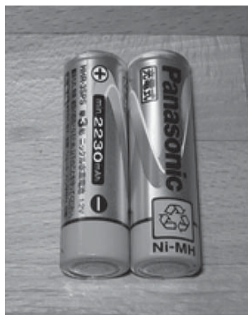
写真2 元の電池（左）と熱収縮チューブで修理した電池（右）
