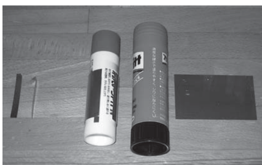
写真 4 負極集電体（左の 2 本）、負極活物質（右の 1 枚）、スティック糊の胴部と胴部に巻かれた亜鉛板（中央の右と左）
