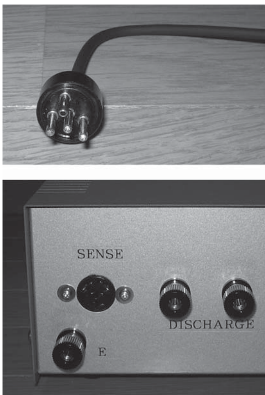
写真3 電池電圧測定用のクリップ付きコードのプラグ(上)とケースのジャック(下)
