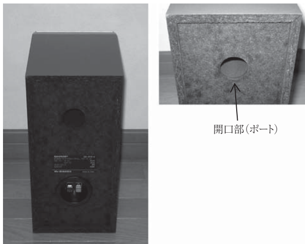
写真2 SD-AT10-S の裏面と開口部
