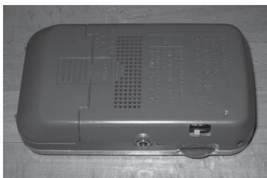
写真7 改造後の電源スイッチとボリューム
